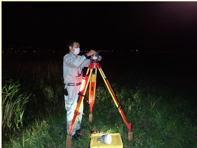
GNSS測量器の設置
