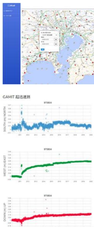
図-3 公開予定の地盤情報システム (JISLaD) の例。CSV形式で任意の点の座標値をダウンロードできる。なお、2011年3月11日の変動は大変大きく、元のままでは普段の変動が見えないので、この図ではそれをつないでいる
