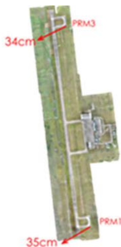
図-1 フィリピン、ジェネラルサントス空港の1次基準点の2002年～2019年の水平変動。下絵はUAV測量によるオルソ画像
